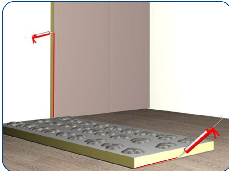
**4.** Applicare i pannelli a parete collocandoli verticalmente, in aderenza, aiutandosi con una leggera pressione fino a allinearne il perimetro col perimetro precedentemente tracciato. In caso di necessità si provveda ad un fissaggio meccanico di sicurezza per mantenere in posa le lastre durante la fase di asciugatura del collante. Verificare la corretta posa delle lastre con l'ausilio di una stagia o con la verifica delle linee di riferimento del puntatore laser.
