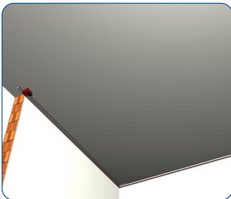
**2.** Montare i profili perimetrali, completi di nastro di guarnizione in polietilene.
