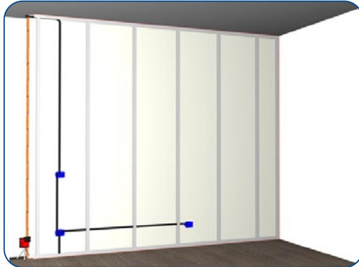
**4.** Applicare tra montante e montante i pannelli STIFERITE GT di spessore idoneo ad essere inserito all'interno dei profili metallici; la larghezza di 600 mm dei pannelli corrisponde al passo dei montanti fungendo da guida e riducendo lo sfrido dell'isolante.
