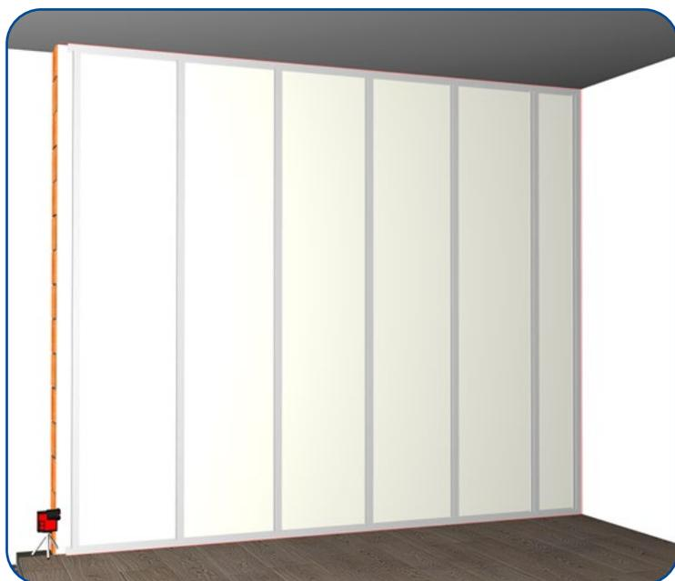
**2.** Montare i profili perimetrali, completi di nastro di guarnizione in polietilene, ed i montanti, come da specifiche del produttore del sistema strutturale adottato, procedendo all'ancoraggio dei profili perimetrali con adeguati fissaggi meccanici.
