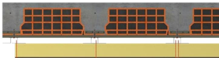
Posa a controsoffitto con pannello isolante inserito nella struttura per cartongesso - Pag. 29
