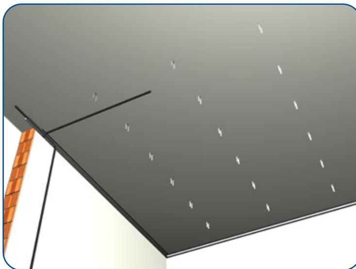
**4.** Posare i traversi ed ancorarli sui profili perimetrali e sulle sospensioni; infine piegare il profilo in eccedenza delle sospensioni.
