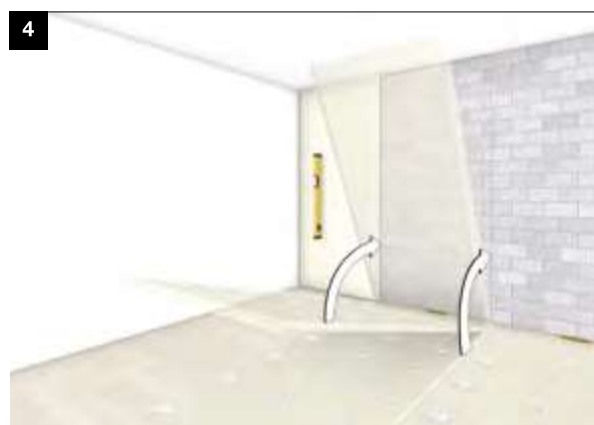
4. POSIZIONAMENTO LASTRE SULLA PARETE
