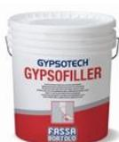
Lo stucco in pasta pronto all'uso **GYPSOFILLER** (conforme a EN 13963) è un prodotto specifico per il trattamento dei giunti con nastro in carta microforata. Oltre che per stuccare, è idoneo anche per rasare a piena superficie pannelli in cartongesso. Viene utilizzato anche su supporti quali calcestruzzo, intonaco e mattone.
