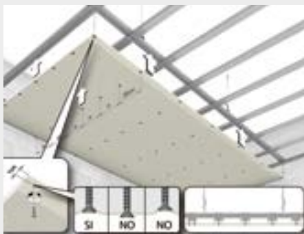
7. Avvitatura delle lastre
