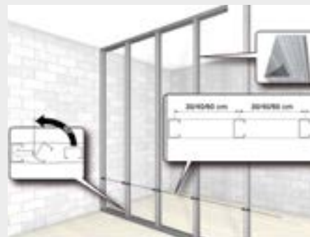
6. Inserimento e posizionamento dei montanti
