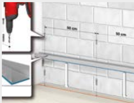
2. Posizionamento e fissaggio guida a pavimento
