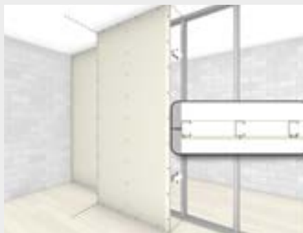
8. Posizionamento e avvitatura delle lastre successive
