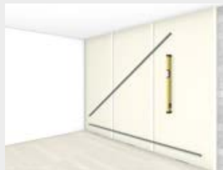
5. Allineamento delle lastre
