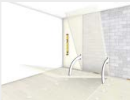
4. Posizionamento lastre sulla parete
