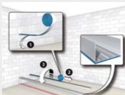
2. Eventuale posa nastro polietilene sotto la guida a pavimento
