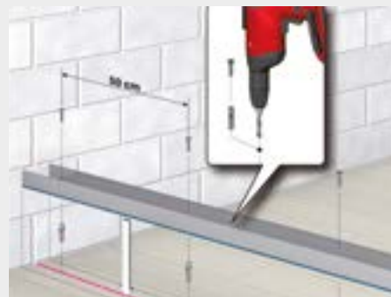
3. Posizionamento e fissaggio guida a pavimento
