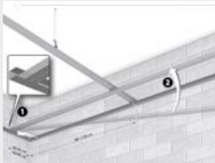
5. Inserimento profili primari nelle guide e successivo aggancio ai pendini
