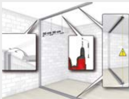
5. Posizionamento e fissaggio guida a soffitto
