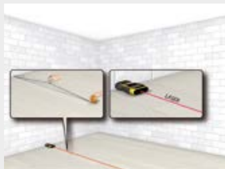
1. Tracciamento guida a pavimento Si utilizza un laser o un comune metro
