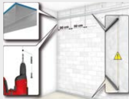
3. Posizionamento e fissaggio guida a soffitto
