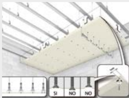
7. Avvitatura delle lastre
