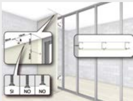
7. Posizionamento e avvitatura del primo strato di lastre
