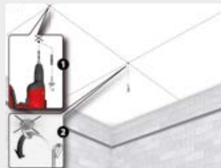
3. Tracciamento interasse profili e pendini e fissaggio pendinatura
