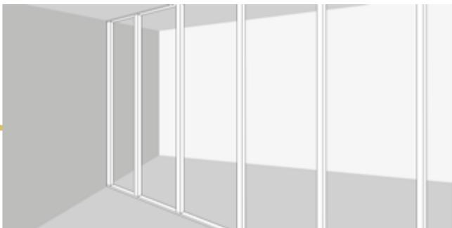
Procedere con la normale applicazione dell'orditura metallica e con la posa delle lastre. Sulla superficie della parete appena realizzata tracciare la sagoma dell'elemento Gypsocomete. Successivamente si procederà analogamente come riportato per l'applicazione "parete esistente".
