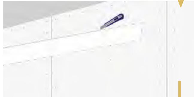
Eeguire il taglio della/e lastre mediante l'utilizzo di un cutter, aumentando la larghezza del foro di ca. 2/3 mm di spessore rispetto al filo sagoma. Nel caso di doppia lastra conservarne un pezzo. Si dovrà prestare attenzione ai profili sottostanti.
