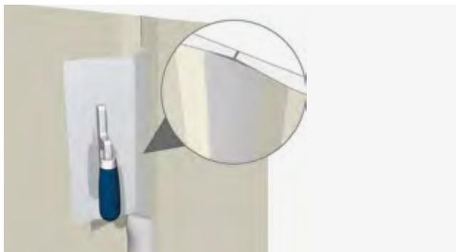
3-Applicazione del nastro d'armatura facendolo aderire allo stucco con l'aiuto della spatola ed eliminazione dello stucco in eccesso
