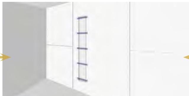
Una volta rimossa la lastra/e si procederà con il rinforzo del foro mediante profili a C 48/15 o 48/27 posizionati perpendicolarmente al foro ed a interasse massimo di 400 mm, utilizzando normali viti auto perforanti ad una distanza di circa 3/4 cm dal bordo. Il primo e l'ultimo profilo andranno posizionati a metà tra il filo della lastra ed il filo del foro, in modo da ottenere una rigidità maggiore.
