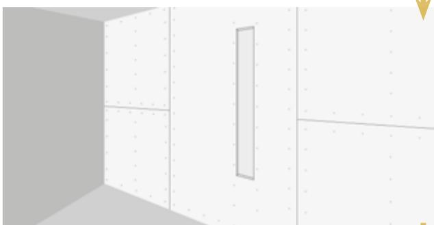
Avvitare l'elemento Gypsocomete mediante viti autoperforanti ad una distanza circa di 3/4 cm dal bordo. Nel caso di doppia lastra prima dell'applicazione dell'elemento Gypsocomete si avviterà un pezzo al fine di creare lo spessore necessario.
