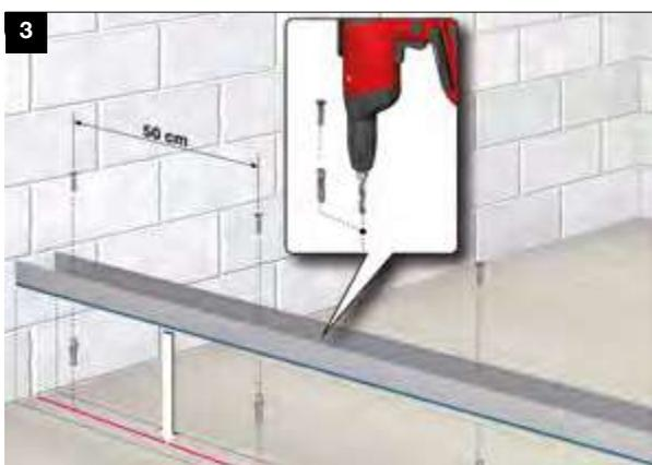
**3. POSIZIONAMENTO E FISSAGGIO GUIDA A PAVIMENTO**
