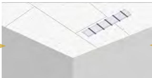
Una volta rimossa la lastra/e si procederà con il rinforzo del foro mediante profili a C 48/15 o 48/27 posizionati perpendicolarmente al foro ed a interasse massimo di 400 mm, utilizzando normali viti autoperforanti ad una distanza di circa 3/4 cm dal bordo. Il primo e l'ultimo profilo andranno posizionati a metà tra il filo della lastra ed il filo del foro, in modo da ottenere una rigidità maggiore.
