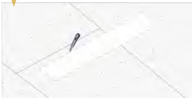
Eeguire il taglio della/e lastre mediante l'utilizzo di un cutter, aumentando la larghezza del foro di ca. 2/3 mm di spessore rispetto al filo sagoma. Nel caso di doppia lastra conservarne un pezzo.
