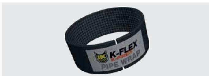
Il K-FLEX® K-FIRE WRAP è un dispositivo di chiusura per tubazioni ideato per sigillare attraversamenti di tubazioni combustibili, tubazioni combustibili coibentate in pareti e solette. Il K-FLEX® K-FIRE WRAP è fornito in sacchetti di polietilene pre-dimensionato a seconda del diametro del tubazione. La striscia è avvolta attorno alla tubazione e spinta nell'apertura dell'elemento di separazione o inglobato nel getto con K-FLEX® K-FIRE EX MORTAR.
