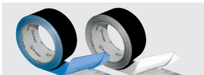
Nastro in alluminio nero o bianco laccato da 30 micron (1.2 mil), combinato con un solvente adesivo acrilico per basse temperature, protetto da una carta siliconata di facile rilascio o da un rivestimento siliconato in polietilene Blu. Versione Cold Weather (per basse temperature).
