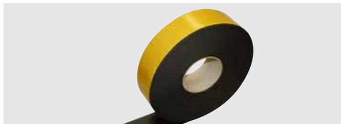
Elastomerico espanso a cellule chiuse (FEF) altamente flessibile, adatto per l'isolamento termico caldo e freddo, con una combinazione di bassa conducibilità termica, alta resistenza alla diffusione del vapore acqueo e bassa propagazione della fiamma.
